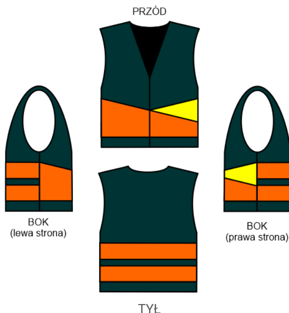
Rys. 2. Przykład rozmieszczenia materiału fluorescencyjnego w kamizelce o zwiększonej widzialności typu A (widok z przodu, z tyłu, prawego i lewego boku)
