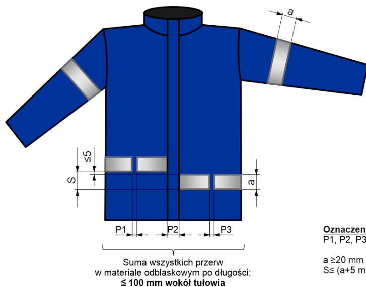
Rys. 8. Graficzna interpretacja wymagań odnośnie dopuszczalnych przesunięć i przerw w materiale odblaskowym w wyrobach odzieżowych typu B3 (na tułowiu)
